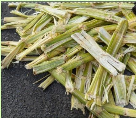
La “bagassa” è il sottoprodotto utilizzato come combustibile per le caldaie della fabbrica di zucchero
